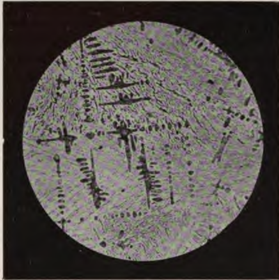
Fig. 115. Die dunkeln, tannenbaumförmig angeordneten Bestandteile sind die primär ausgeschiedenen Mischkristalle; die Grundmasse Eutektikum Mischkristalle-Carbid.
